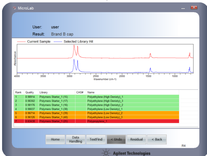
Hình 10. Phân tích định tính nắp chai bằng máy quang phổ Agilent FTIR Cary 630 (đường màu đỏ) và kết quả đối chiếu thư viện (đường màu xanh). Bảng hiển thị chỉ số độ trùng khớp, thư viện sử dụng và tên mẫu đối chiếu cho cả hai thương hiệu A và B.
