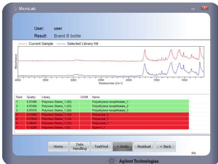
Hình 9. Phân tích định tính vỏ chai bằng máy quang phổ Agilent FTIR Cary 630 (đường màu đỏ) và kết quả đối chiếu thư viện (đường màu xanh). Bảng hiển thị chỉ số độ trùng khớp, thư viện sử dụng và tên mẫu đối chiếu cho cả hai thương hiệu A và B.
