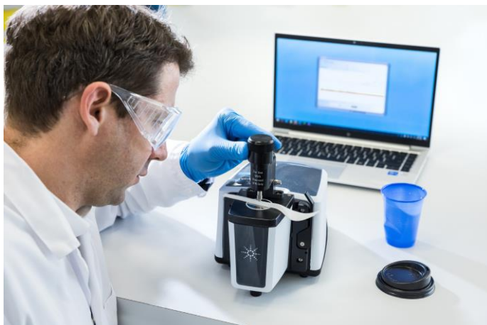
Hình 2. Máy quang phổ Agilent FTIR Cary 630 với mô-đun ATR bằng kim cương.
