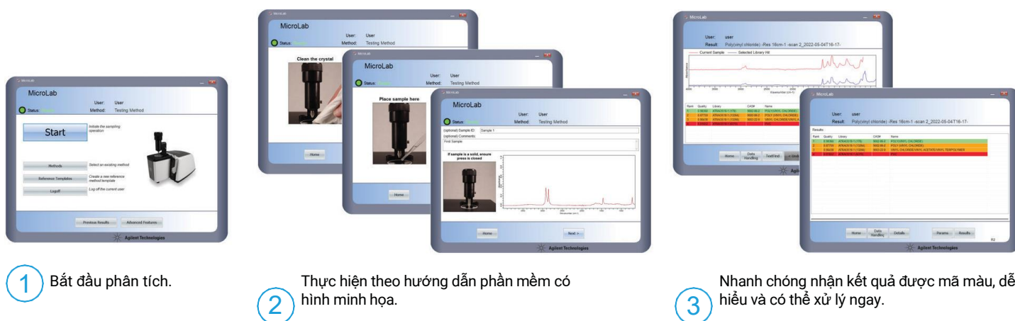
Hình 11. Quy trình làm việc trực quan của phần mềm Agilent MicroLab PC giúp việc tìm kiếm kết quả với máy quang phổ FTIR Agilent Cary 630 trở nên đơn giản. Phần mềm có hướng dẫn bằng hình ảnh cũng giúp giảm nhu cầu đào tạo và hạn chế rủi ro sai sót do người dùng.
