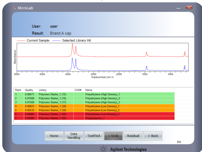
Hình 10. Phân tích định tính nắp chai bằng máy quang phổ Agilent FTIR Cary 630 (đường màu đỏ) và kết quả đối chiếu thư viện (đường màu xanh). Bảng hiển thị chỉ số độ trùng khớp, thư viện sử dụng và tên mẫu đối chiếu cho cả hai thương hiệu A và B.
