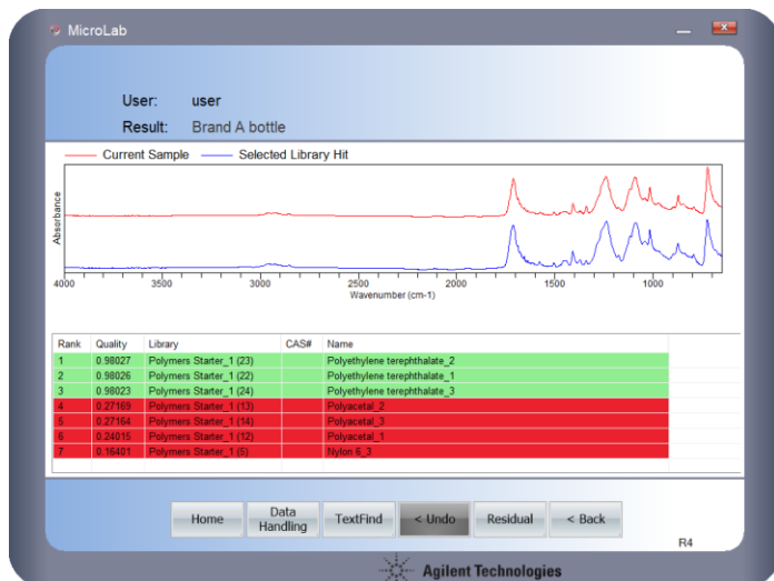
Hình 9. Phân tích định tính vỏ chai bằng máy quang phổ Agilent FTIR Cary 630 (đường màu đỏ) và kết quả đối chiếu thư viện (đường màu xanh). Bảng hiển thị chỉ số độ trùng khớp, thư viện sử dụng và tên mẫu đối chiếu cho cả hai thương hiệu A và B.
