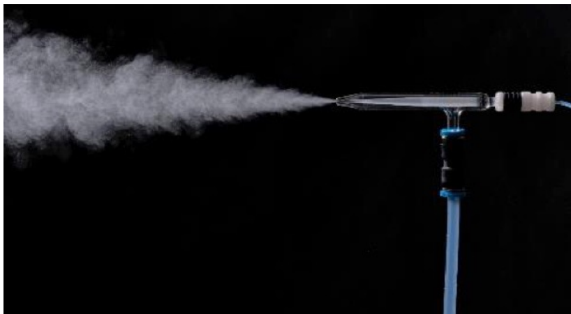
Hình 12. Các mẫu thường được đưa vào dưới dạng lỏng để đo bằng bất kỳ kỹ thuật quang phổ nguyên tử nào. Tất cả các kỹ thuật, ngoại trừ GFAAS, đều sử dụng máy phun sương để biến mẫu chất lỏng thành sương mù dạng khí dung. GFAAS tiêm mẫu chất lỏng bằng ống tiêm.
