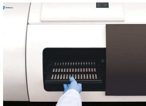
2. Đặt khay vào thiết bị để phân tích. Không cần chuẩn bị mẫu.
