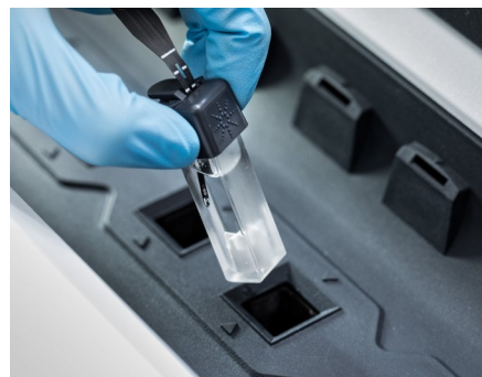
Hình 8. Đầu dò nhiệt độ trong cuvette độc đáo của Agilent Cary 3500 UV-Vis có chu kỳ phản hồi siêu nhanh. Đầu dò cung cấp các phép đo nhiệt độ tức thời, trực tiếp từ mẫu.
