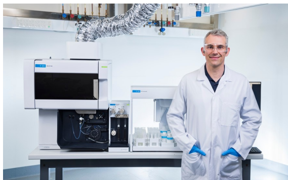
Hình 10. Hệ thống tự động hóa ICP bao gồm: Thiết bị phân tích + Bộ lấy mẫu tự động + Van chuyển dòng AVS + Bộ pha loãng tự động ADS 2.
